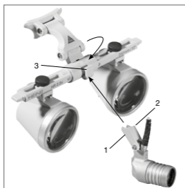
Abb. 6 Montage des Kopfbandreglers
