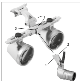
Figur 6 Montering af hovedbåndsregulatoren
